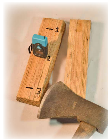
Mesurer la teneur en humidité de la surface fraîche fendue, transversalement au grain, à ces points
