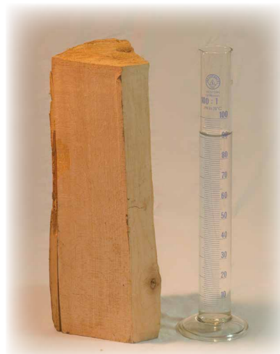
90 ml d'humidité dans 600gr de hêtre (15% d'humidité)
